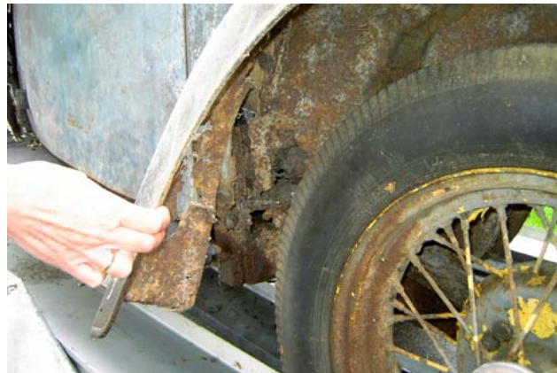
4) Verbindung B-Säule / Schweller fehlte völlig
