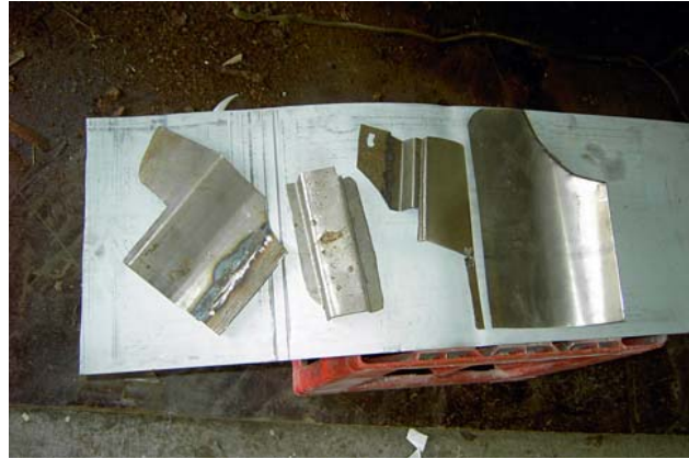
28) passend angefertigte Bleche einschweißen
