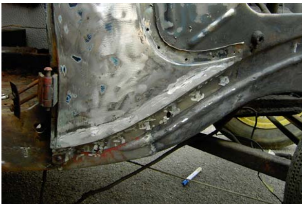
31) Dem Farbanstrich einer Bitumenfarbe, war nur mit Handschleifer und Zopfbürste beizukommen
