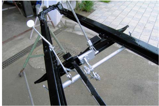
41) Fertig entrostet und lackiert. Die ersten Anbauteile, hier Bremswelle mit Pedal, sind schon wieder eingebaut
