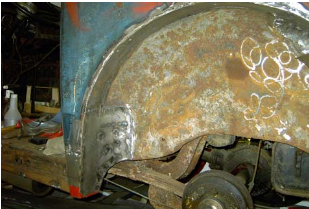
29) die B-Säulenbasis ist fertig
