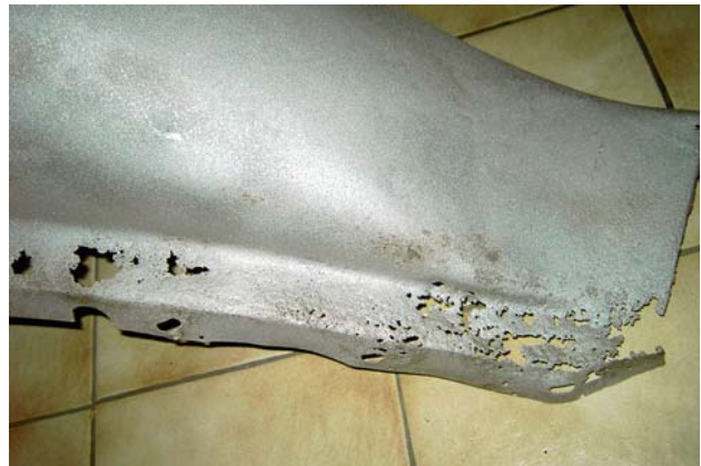
42) Getreu dem Grundsatz «so viel alte Substanz wie möglich zu erhalten», wurden die Kotflügel nur partiell mit neuen Reparaturblechen versehen
