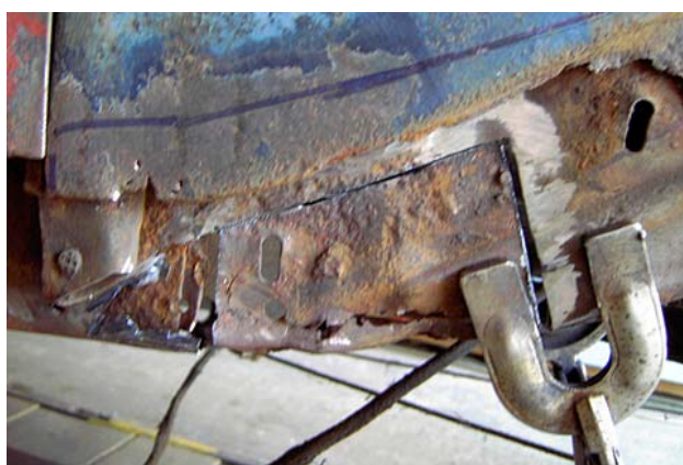
25-26) Schadhafte Stellen wurden herausgetrennt und Reparaturbleche eingeschweißt
