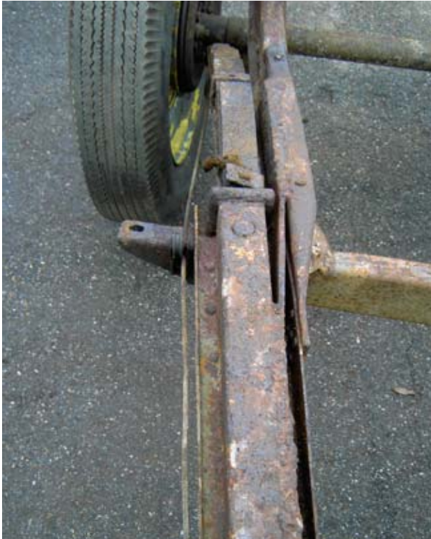
40) Der Rahmen war durch Überlastung wohl mal abgeknickt. Ein massives Flacheisen war beidseitig zur Verstärkung eingeschweißt – ich ließ es drin
