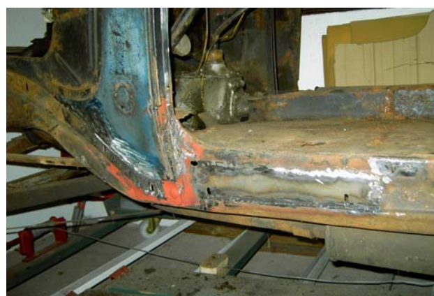
25-26) Schadhafte Stellen wurden herausgetrennt und Reparaturbleche eingeschweißt
