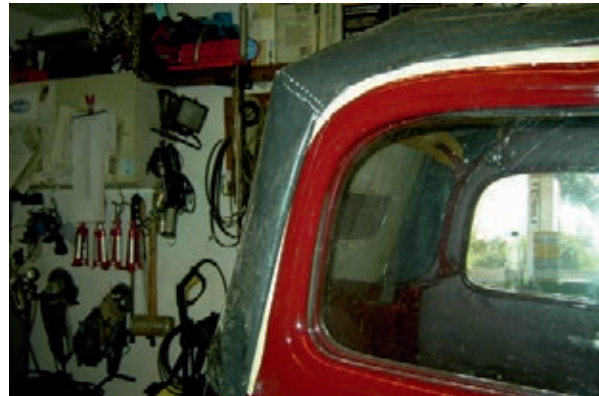
21) Genäht konnte das Dach sogar gespannt werden
