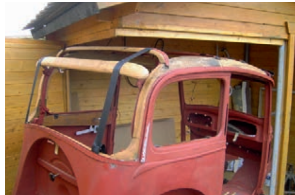
16-17) Präzisionsarbeit in Eichenholz. Zum Schluss machte der gute Winkelschleifer mit einer groben Fiberscheibe alles schön glatt und passig.
