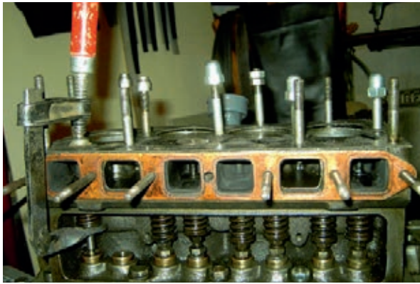
29-30) Ventildedern lahm, Führungen ausgeschlagen... Wer gut schmiert der gut fährt (nicht immer).
