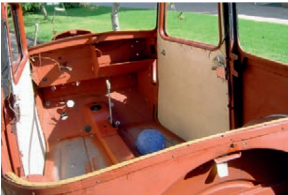
41-42) Der Handbremshebel darf nicht am Armaturenbrett anschlagen... Das Puzzle muss erst passend gemacht werden.
