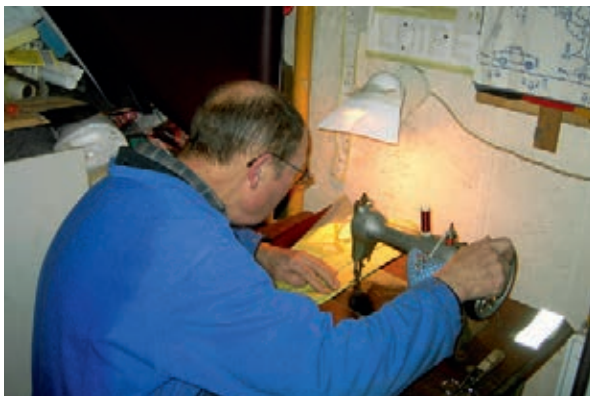
22) Die Kunstlederteile wurden erst geheftet und dann doppelt durchgenäht.
