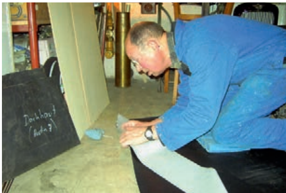
22) Die Kunstlederteile wurden erst geheftet und dann doppelt durchgenäht.
