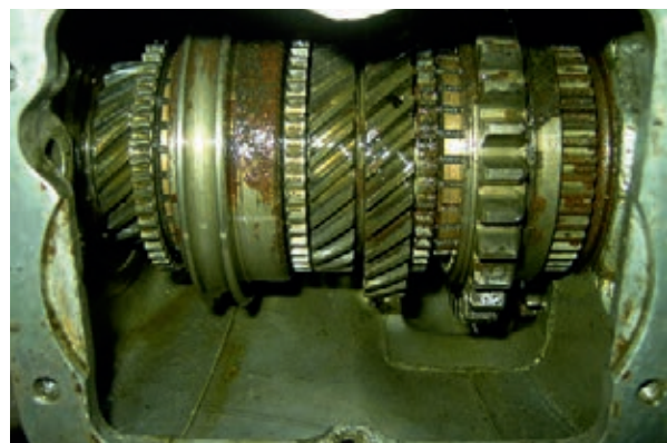
32-33) Der Schein trägt. (Außen hui, Innen pfui)... Fortgeschrittene Karies an den Zähnen...
