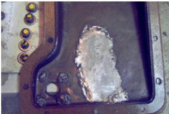
27) Die undichten Stellen der Ölwanne wurden mit einem «Zinnbad» abgedichtet
