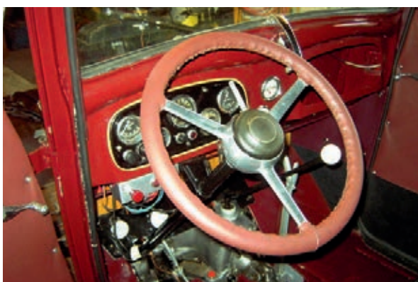
63) Zusatzschalter für Warnblinker und Blinker
