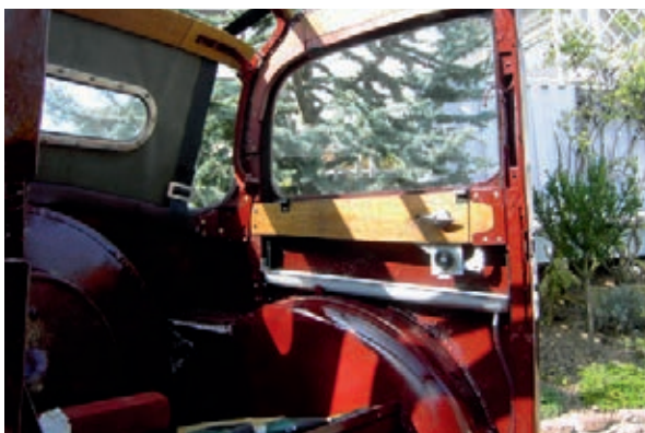
58) Regenrinne mit Ablauf unter den hinteren Kurbelfenstern.
